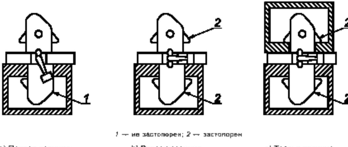
Рисунок В.3 — Полуавтоматический двухсторонний стопор, установленный в верхний угловой фитинг
