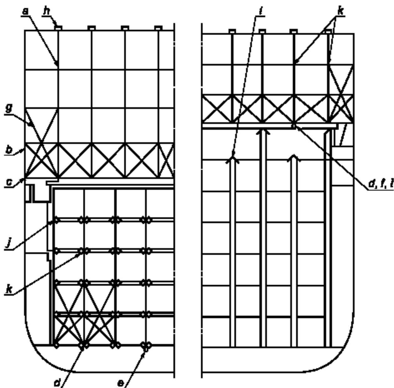
Рисунок 22 — Пример типового оборудования для крепления контейнеров
