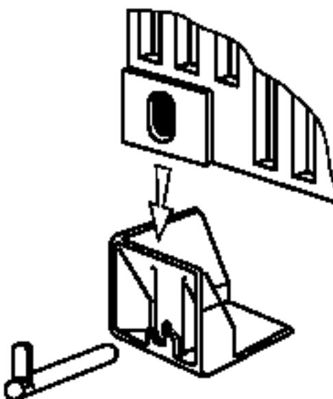
Рисунок 28 — Углковый направляющий ограничитель со стопорным пальцем
