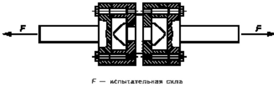
Рисунок А.10 — Испытание стопора (твистлока) на растяжение
