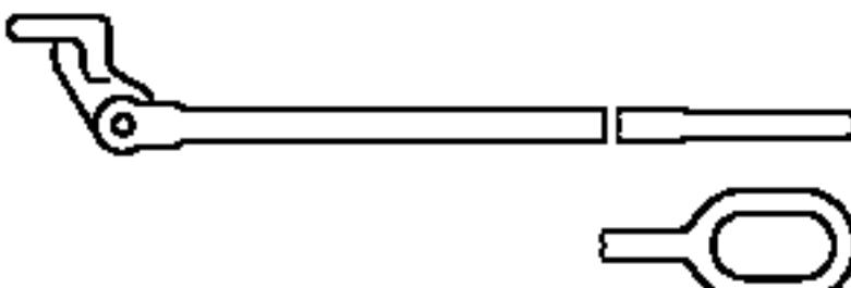
Рисунок D.4 — Контейнерная штанга с шарнирным оголовком
