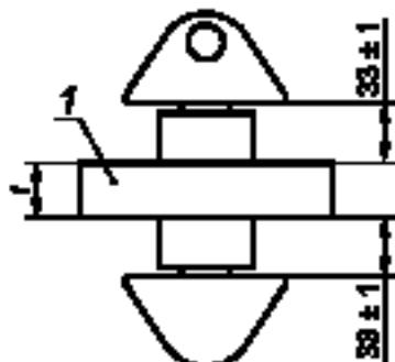
1 — промежуточная пластина;  $t$  — толщина промежуточной пластины
