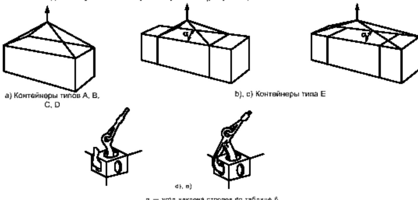
$\alpha$  — угол наклона стропов по таблице 8
