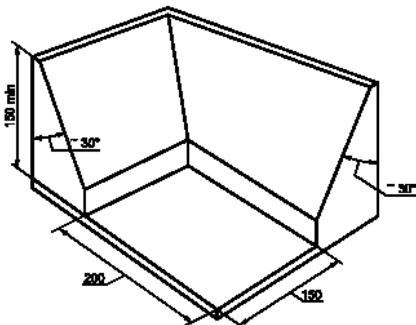
Рисунок 24 — Пример углковой направляющей с горизонтальным упором
