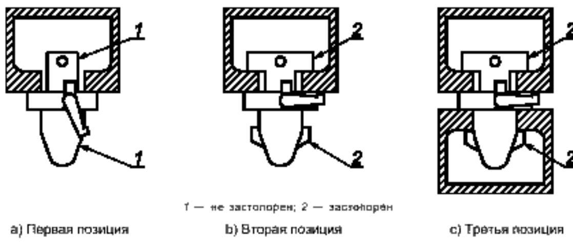
Рисунок В.2 — Полуавтоматический стопор, установленный в нижний угловой фитинг
