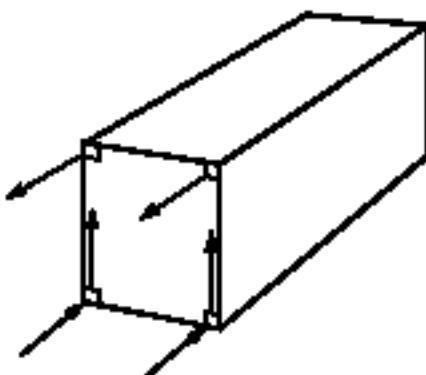
Рисунок 12 — Подъем за торцевые угловые фитинги (способ 1)
