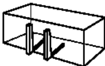
Рисунок 15 — Подъем вилочным захватом
