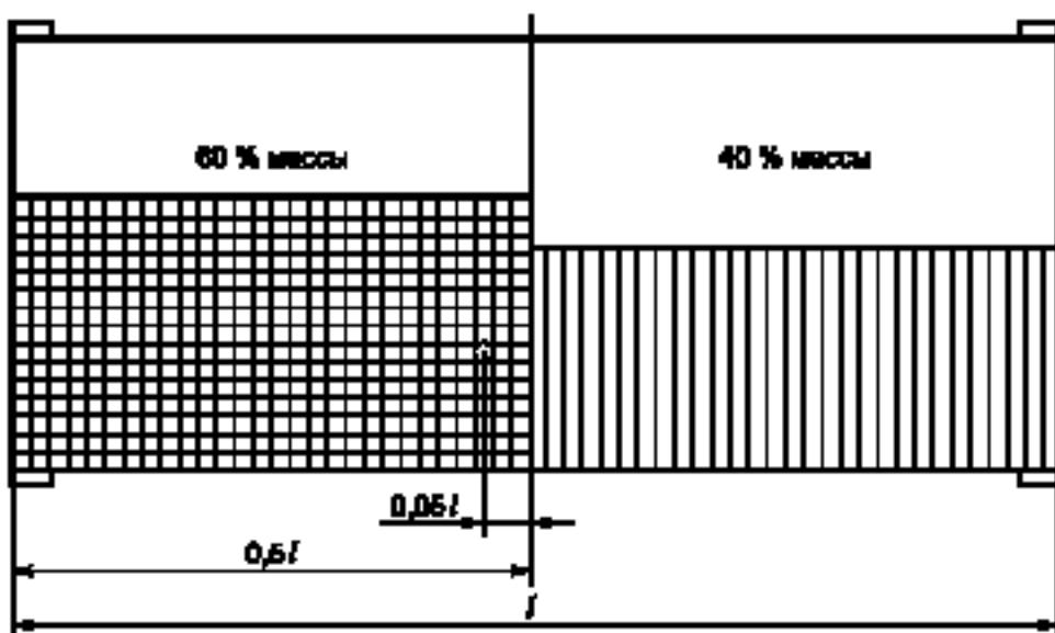
Рисунок 1 — Распределение нагрузки
