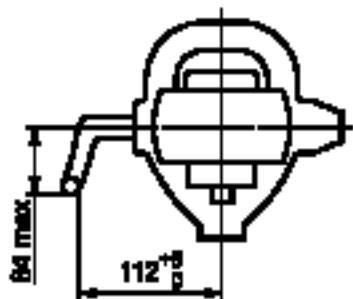
Рисунок В.5 — Длина рукоятки, работающей в вертикальной плоскости
